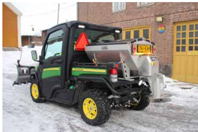
Rozmetadlo 380 I na John Deere Gator
