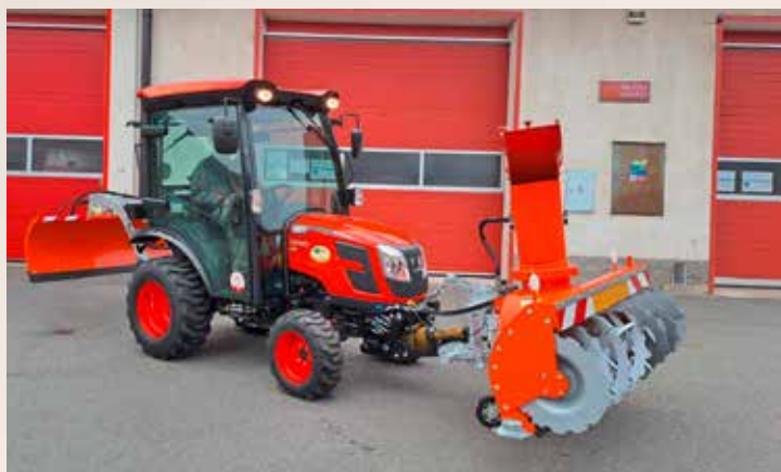
Traktor Kioti CX2510CH se zadní sněhovou radlicí Agrometall a čelní frézou na sníh Agrometall
